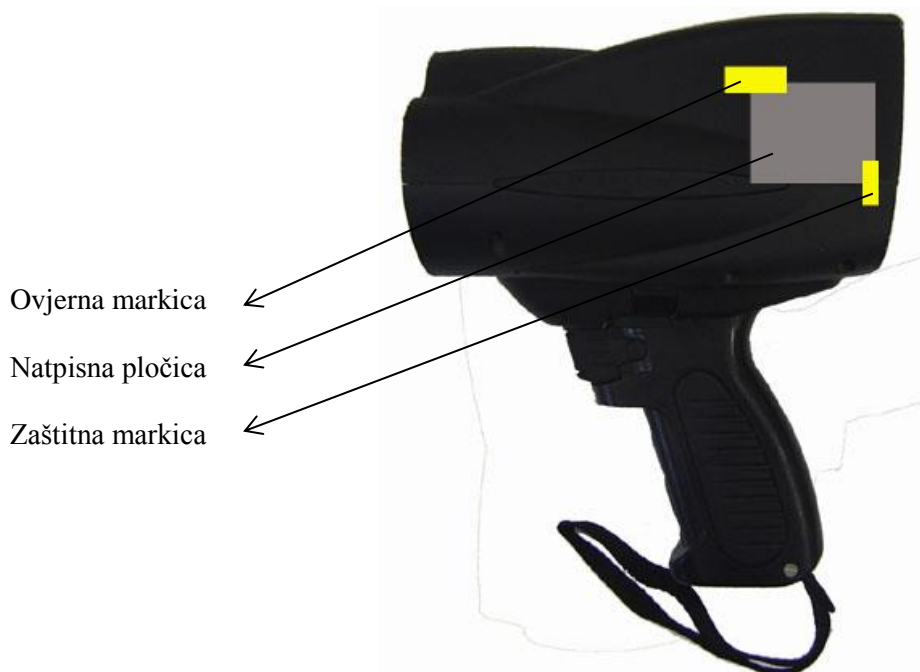
Slika 10. Postavljanje ovjerne markice, natpisne pločica i zaštitne markice
